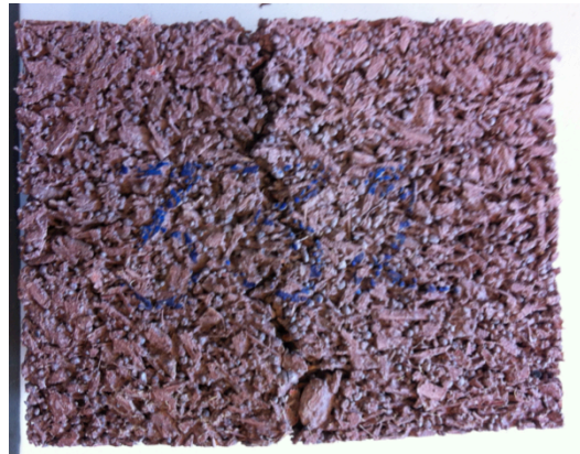
FIGURE 79 - FISSURE DE RUPTURE DANS L'ÉPROUVETTE 3V32
