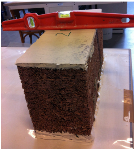
FIGURE 72 - VÉRIFICATION DE PLANÉITÉ DU BLOC
