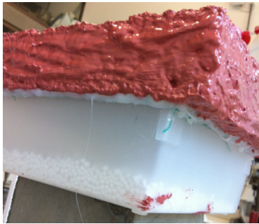
FIGURE 54 - SCELLAGE DE L'ÉCHANTILLON SUR LA COUPELLE CONTENANT DU \text{CaCl}_2
