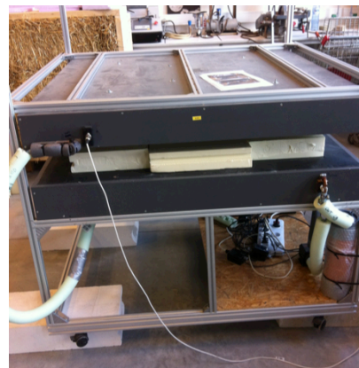
FIGURE 62 - PLAQUE SUPÉRIEURE REDESCENDUE, ESSAI EN COURS
