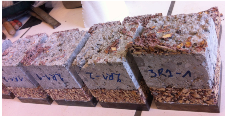
FIGURE 70 - RUPTURE DANS LES BLOCS 60% HR
