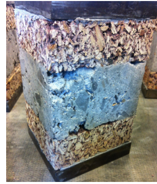
FIGURE 68 – DÉFAUTS DANS LE BLOC 2RH3-1
