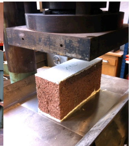
FIGURE 74 - BLOC CENTRÉ DANS LA PRESSE
