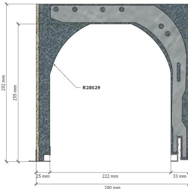
**Option équerres et ligatures [PDF]** : conformément à l'avis technique du CSTB, les coffres renforcés seront ligaturés au chaînage et fixés à la traverse haute au mouen d'équerres. Equerres et ligatures sont livrables en paquet de 500 pièces ou intégrées dans le coffre à la production.
